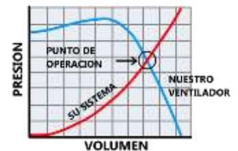
Al seleccionar el ventilador se recomienda usar una transmisión de tipo variable siempre que sea posible para compensar las diferencias entre la presión calculada para el sistema y la presión real en la instalación.
